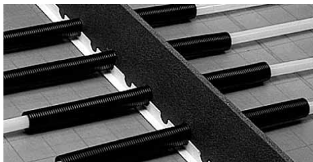
Rys.24 Przykład zabezpieczenie rury grzejnej w szczelinie dylatacyjnej
