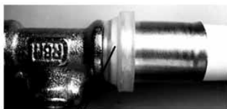
Prawidłowe umieszczenie rury widać przez przezroczysty pierścień dystansowy
